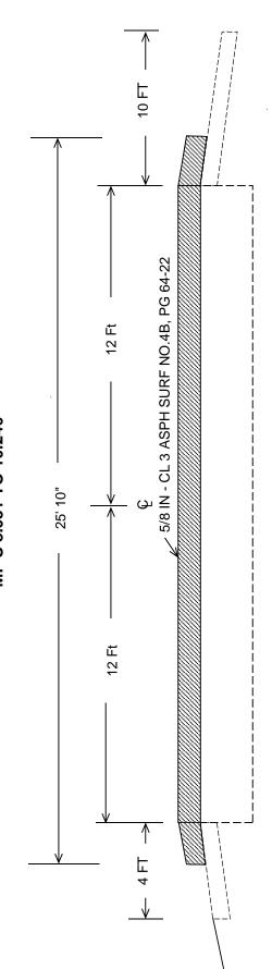
1). OVERLAY INSIDE TO INSIDE EXISTING SAWED RUMBLE STRIPS
